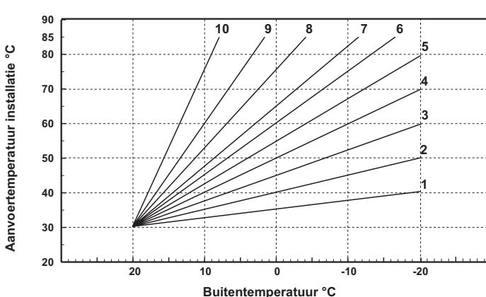
Als de omgevingstemperatuur lager blijkt dan de gewenste waarde wordt aanbevolen een hogere curve in te stellen en omgekeerd. Verhoog of verlaag de curve met één eenheid en verifieer daarna de omgevingstemperatuur.
